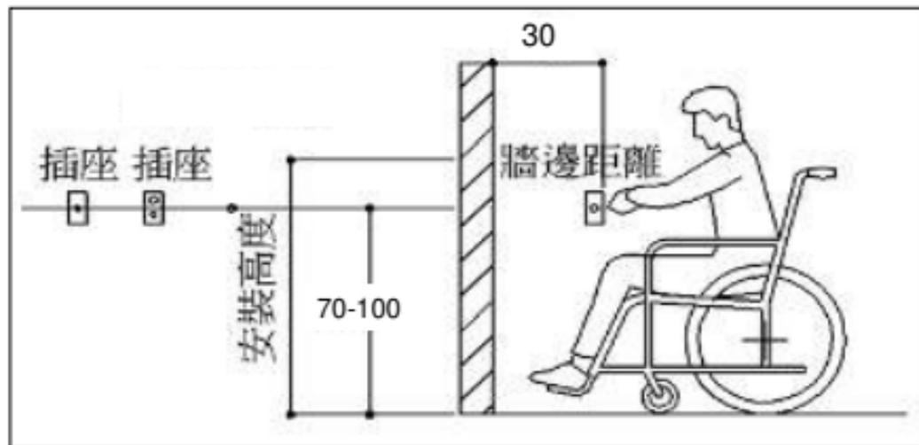
電器及插座開關設置高度應距地板面高 70-100 公分處，設置位置應距柱、牆角 30 公分以上。
