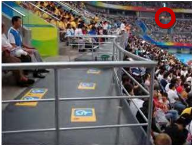
輪椅觀眾席位前有高差應設置欄杆，以防跌落。
